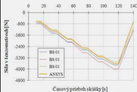
Porovnanie zmeny veľkosti sily v obvodových tlačných prútoch v čase
