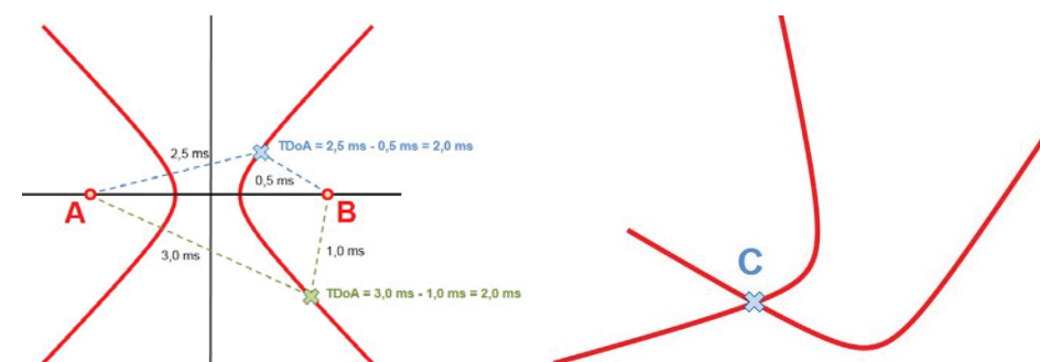
Obr. 3 – Princíp určenie polohy metódou TDoA (vľavo), určenie 2D polohy (vpravo)
