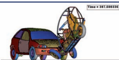
Obr. 4 Deformačný test trojkolesového motocykla pri nárazovej rýchlosti 100km/h. Oidva virtuálne modely sú vytvorené pomocou konečných elementov.
