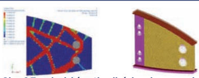
Obr. 6 Topologická optimalizácia rebra nosnej plochy lietadla. Červené plochy sú miesta, v ktorých je nutná prítomnosť materiálu s ohľadom na druh a veľkosť zaťaženia.
